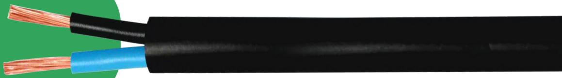
Os cabos Flex PP são empregados em ligações de ferramentas portáteis motorizadas, de excelente acabamento (cobertura brilhante) e grande flexibilidade. Seu uso é ideal para circuitos de alimentação e distribuição de energia elétrica ao ar livre ou subterrâneo com tensões nominais de tensão 350/500 V.
